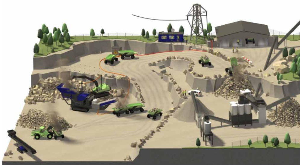
Figur 26: En helt automatisk, eldriven och förarlös bergtäkt – styrd av ett gemensamt datasystem presenterat av Volvo Construction Equipment på Energimyndighetens elfordonkonferens 2017 (32) . Bild: Volvo Construction Equipment, VCE.
